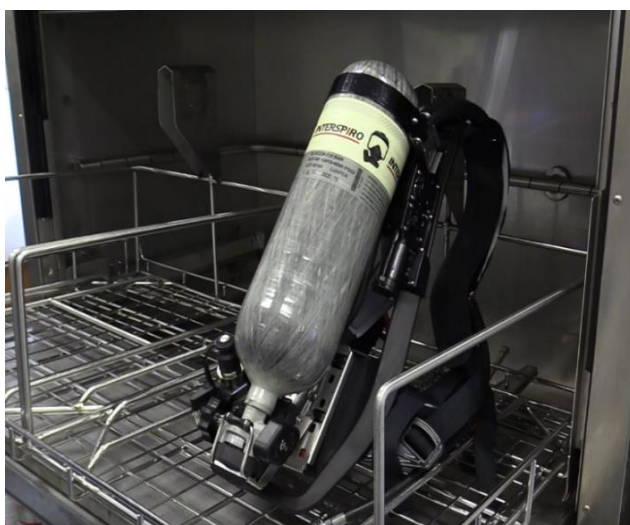
Pusteapparat forbehandlet med FFE Cleaner og vasket i PPE-oppvaskmaskin med FFE Cleaner i 20 min. ved 60 °C.
