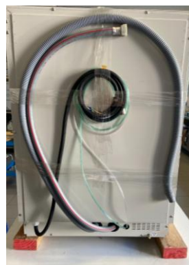
Bakside med slanger og elektrisk tilkobling.
